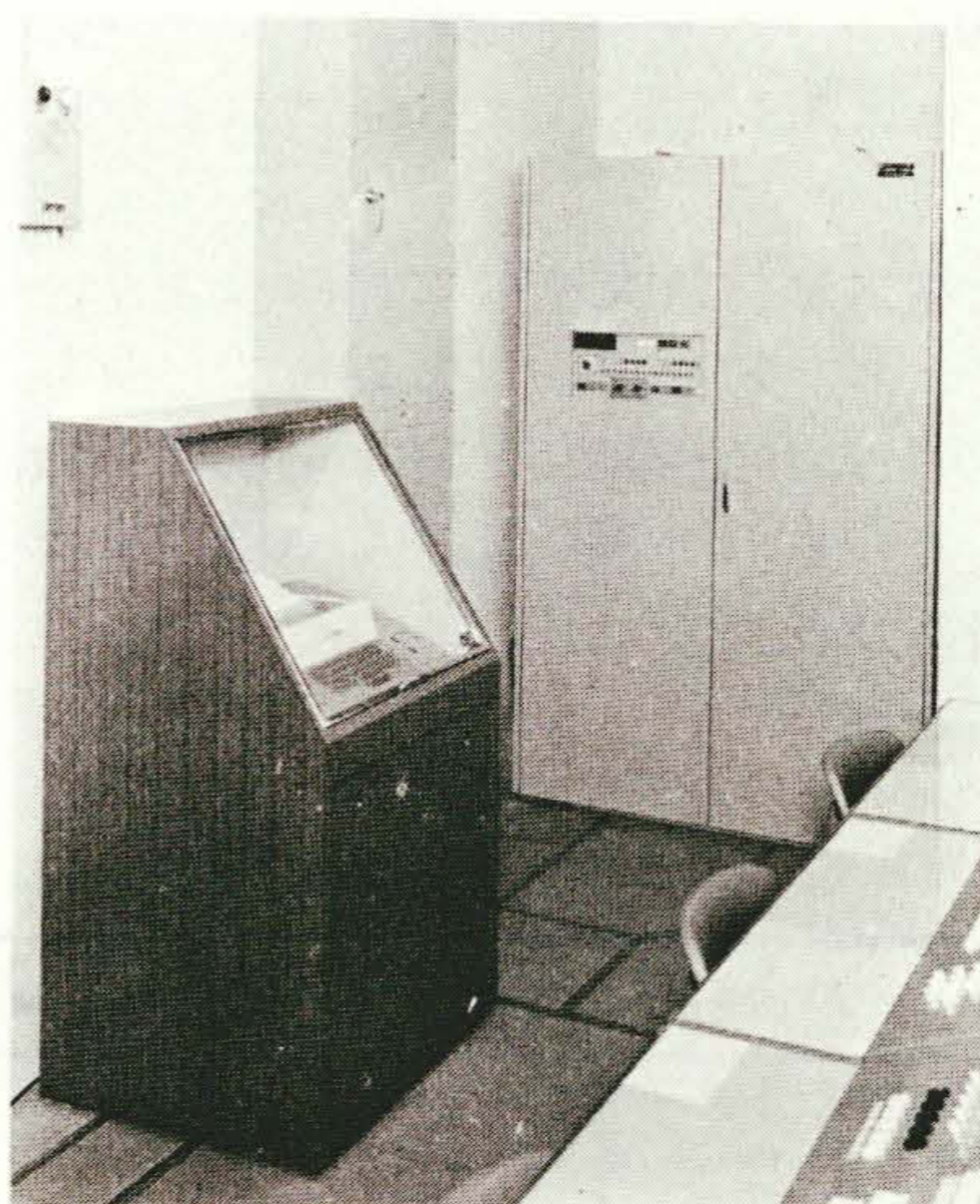
図4 ホテル交換機用の電話料金計算およびモーニングコール装置
