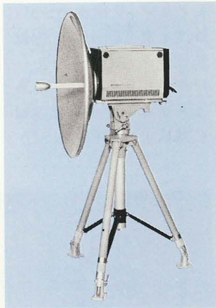
図14 ガンダイオードを用いたテレビジョン中継装置
