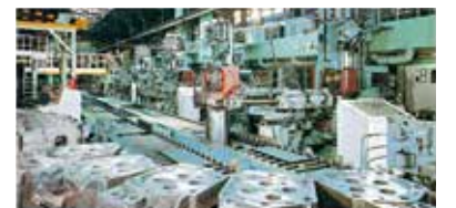
神崎工場のNC工作機によるシリンダヘッド加工 (1968ごろ)
