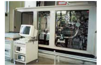
写真8 耐久試験中の超低NOxエンジンTES125
