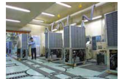
GHPの試運転工程
