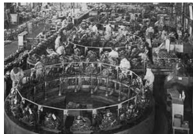
ロータリー式エンジン運転試験台
