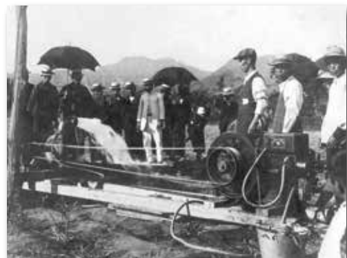
ヤンマー石油発動機とセットされたポンプ
