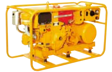
横水F6C形とセットした発電機(3kW)
