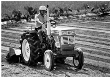
パワーシフトを採用したトラクタYM2210
