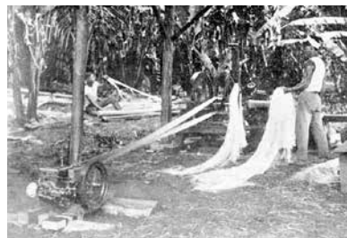
フィリピン・ダバオでヤンマーオフセット式石油発動機を使用した麻引き
