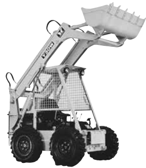
パワーシフト・トランスミッション搭載の ホイールローダ Y30W
