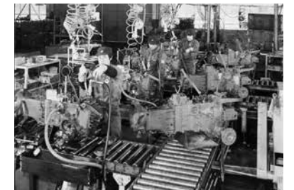
トラクタ用トランスミッション組立ライン (伊吹工場)
