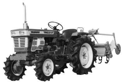
パワーシフト・トランスミッション搭載の トラクタ YM2210
