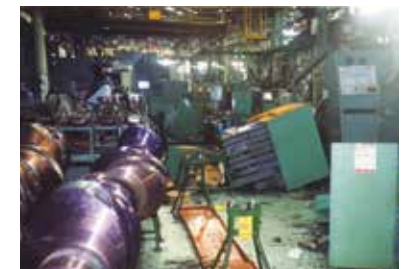
尼崎工場機械加工ラインの被災状況
