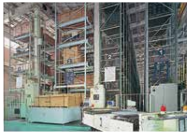
小物部品自動ラック(立体自動倉庫と自動供給装置)
