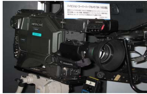
写 3.17 : 超高感度 HV ハープカメラ (技研)
