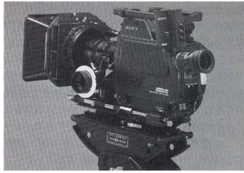
写 3.15 : 可搬型 HV カメラ (ソニー)
