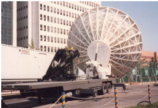
c : 現地送受信設備
