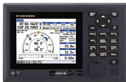
古野電気(株) ご提供 O2 GNSS 航法装置 GP-170
