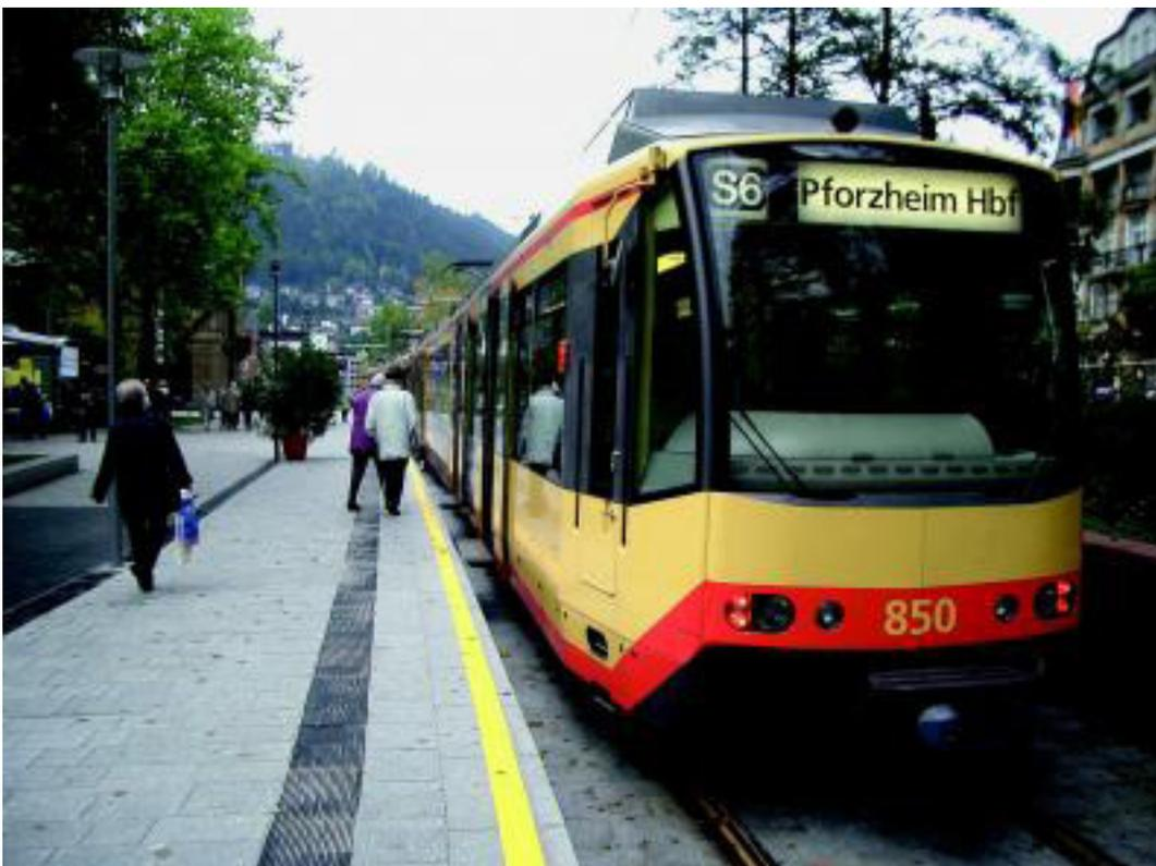
Auf etwa 600 km in der Region um Karlsruhe ermöglichen heute 60 Stadtbahntriebwagen für Gleichspannung und 121 Zweisystemtriebwagen einen dichten Zugbetrieb. Da die Strecken alle von zentralen Stellwerken aus personalsparend überwacht und die Bahnübergänge technisch gesichert sind, ist ein kostengünstiger Betrieb bis spät in die Nacht hinein möglich, was viel zu den immensen Fahrgastzuwächsen beigetragen hat.
