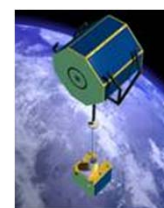
導電性テザーを利用した既存デブリ除去衛星のイメージ
