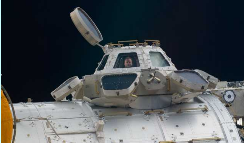
図2-2 キューポラ（写真上が地球側：窓シャッターの開放状態）
