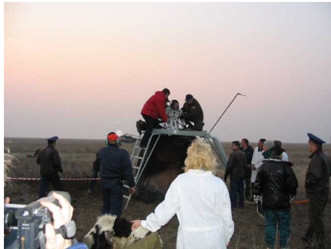
図3.6-3 ソユーズ宇宙船から搭乗クルーを引き出している様子 (カプセルが横倒しにならなかったときは、このように梯子を使って引き上げる)
