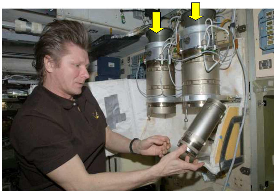
図4.2-3 スズヴェズダ内に設置されているSF6O2容器2本 (矢印) (NASA)
