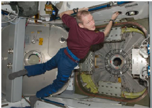
図4.3-7 (上図) 「こうのとりの」到着時の共通結合機構の位置調整作業 (右は、ハーモニーの窓に位置決め用に設置するCBCS (Centerline Berthing Camera System)から撮影した映像。)
