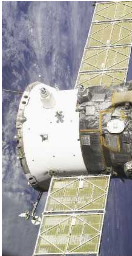
図1.3-1 機器／推進モジュール
