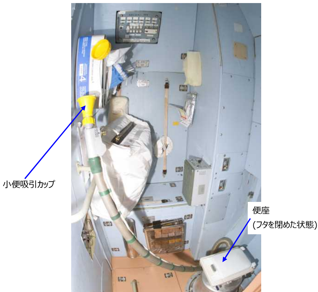
図3.1-6 「ズヴェズダ」後方に設置されているロシアのトイレ(NASA)
