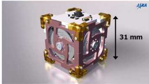
誘導制御計算機・6軸慣性センサ・3軸リアクションホイールを一辺31mmの立方体サイズに集約しました
