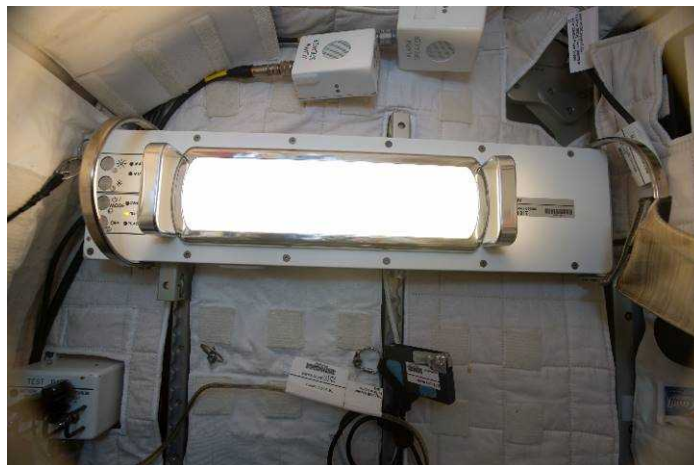
図4.1.2-2 NASAが開発したISS用の新型LED照明
