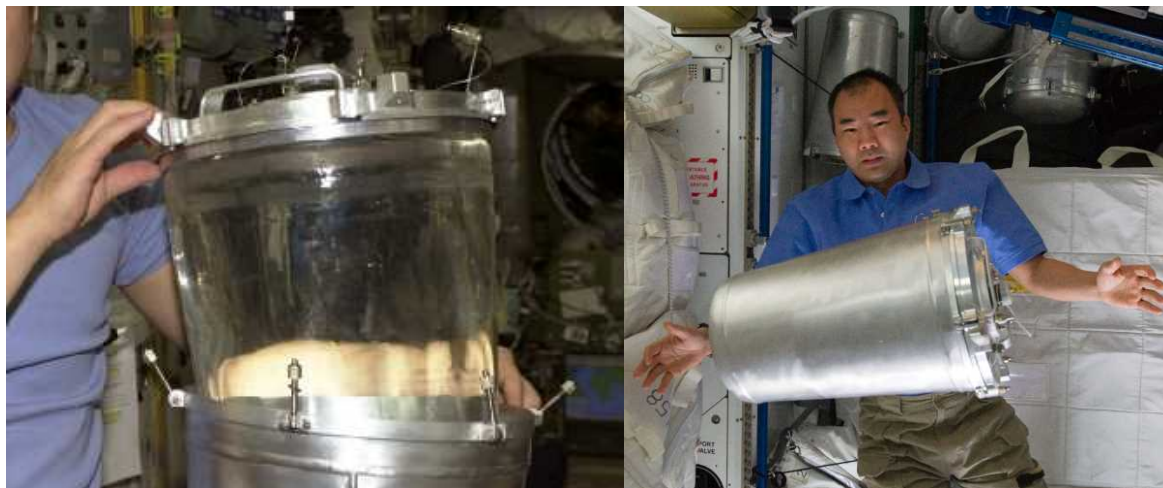
図4.1-5 ロシアの水容器(EDVタンク) (NASA) (ビニールのような容器を金属容器で囲ったもの)
