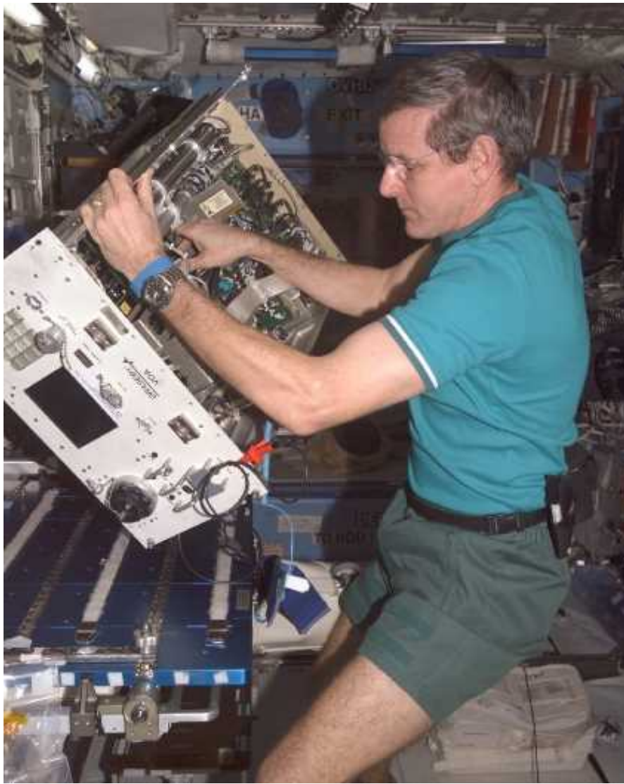
図3.4-3 故障した装置(揮発性有機物分析器(VOA))の修理 (NASA)
