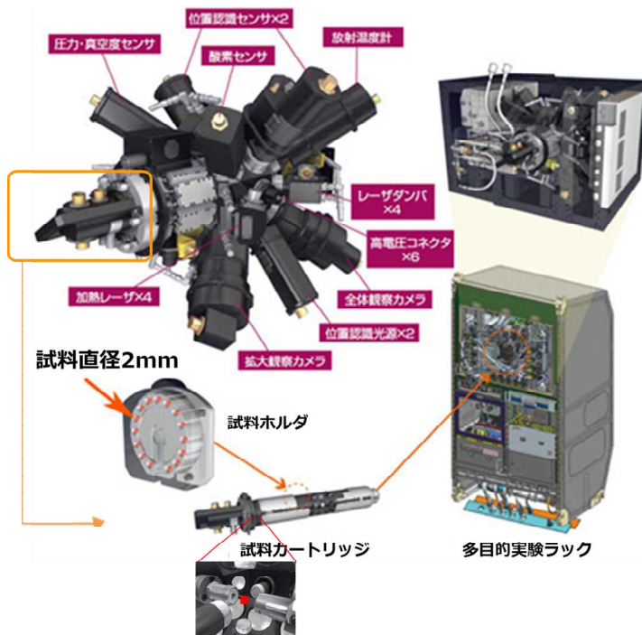
図4.1.1-22 静電浮遊炉(ELF)と、それを収容する多目的実験ラック2(中央右)
