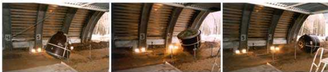
図1.5-1 ソユーズTMA帰還カプセルの落下衝撃試験の様子
