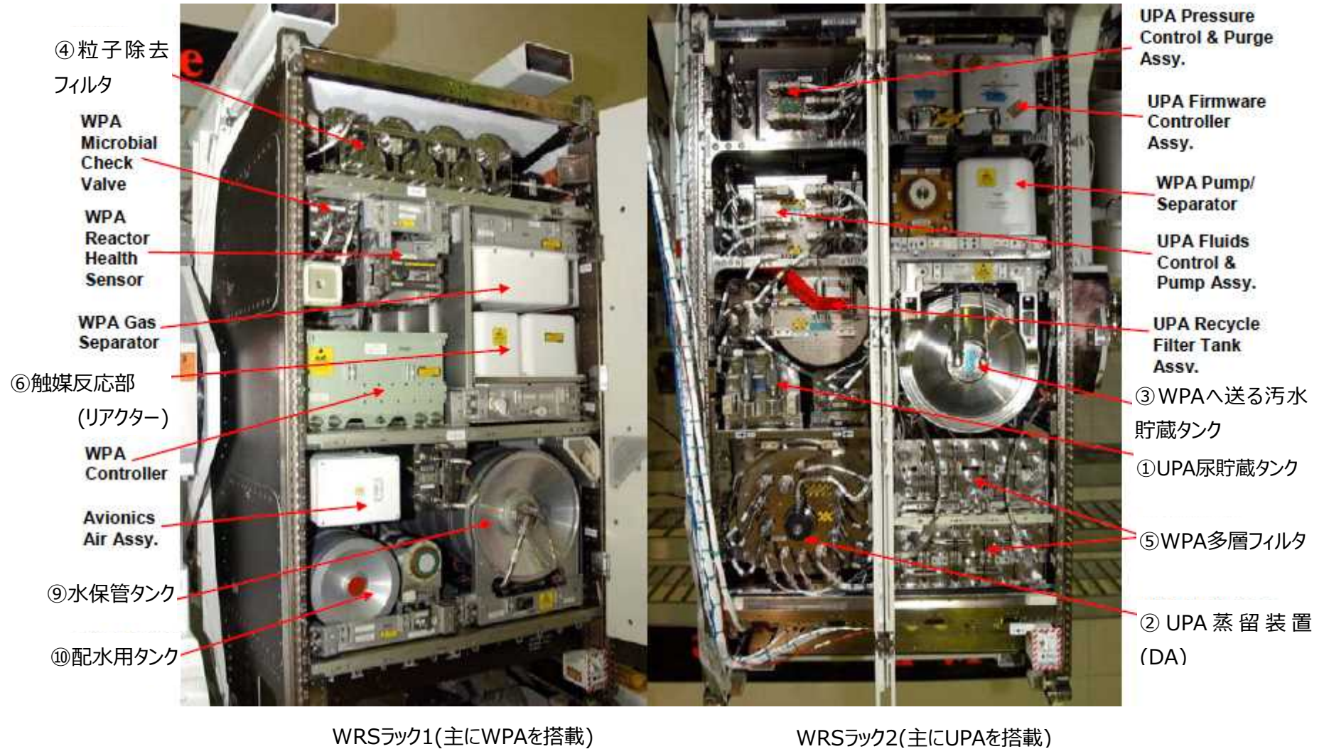
図4.1-1 WRS1, 2ラックの機器構成と水処理の主な流れ (NASA)
