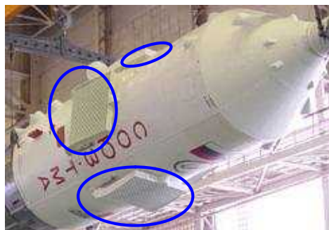
図2.7-2 フェアリング上の空力安定用グリッドフィン (青丸内：メッシュ状で、緊急時には90度下側へ展開)
