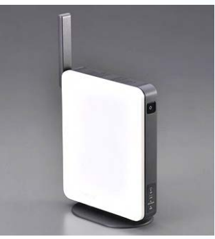
高性能フェムトセル基地局装置
