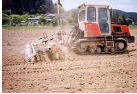
(レーザーレベラーによる均平作業)
