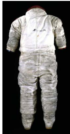
アポロ 17 号ミッションの地球へ持ち返られた船外宇宙服とブーツ。特にブーツや服の下半身部分に月ダストの細かい入り込んでいる状態が著しい。 :出典 NASA
