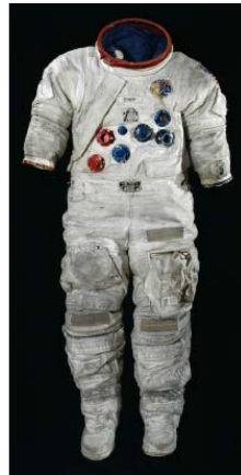
アポロ 17 号ミッションの地球へ持ち返られた船外宇宙服とブーツ。特にブーツや服の下半身部分に月ダストの細かい入り込んでいる状態が著しい。 :出典 NASA
