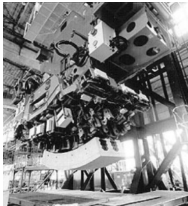
写真3.1.10 セグメント自動組立 ロボット
