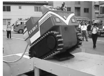
写真4.4.6 消火ロボット
