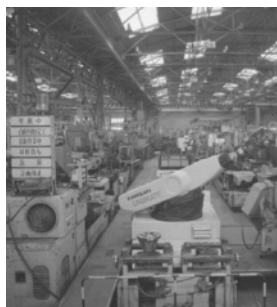
写真2.2.1 油圧装置部品の機械加工セル
