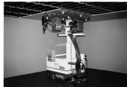
写真3.1.5 内装工事ロボット
