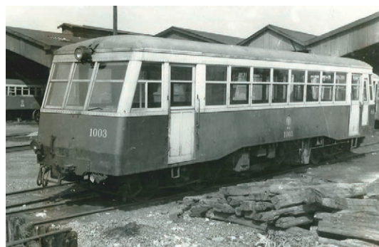
日本最初のディーゼル電動客車キハ1000形気動車 (1935～1946年)
