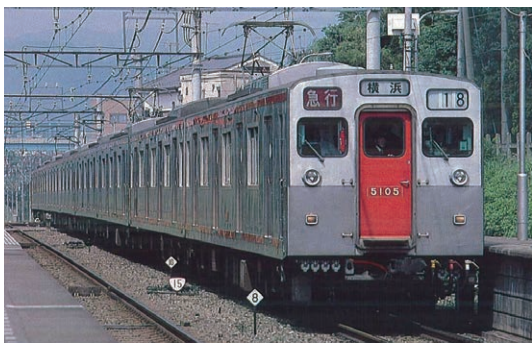
日本で初めて自動窓を採用したアルミ車体の5100系電車 (1972～2009年)
