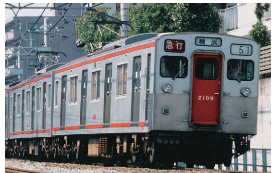
アルミ試作車モハ6021の実績を基に新造したアルミ車体の 2100系電車(1970～2004年)
