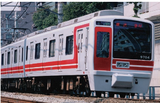
先頭車両前面に曲面ガラスを採用した9000系電車 (1993年～)
