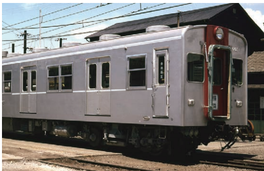
アルミ製車体導入の先駆けとなった6000系試作モハ6021 (1967～1998年)
