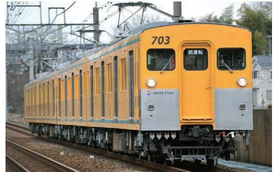
7000系電車を事業用車両に改造した700系電車
