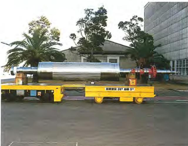
7万kW級超電導発電機回転子
