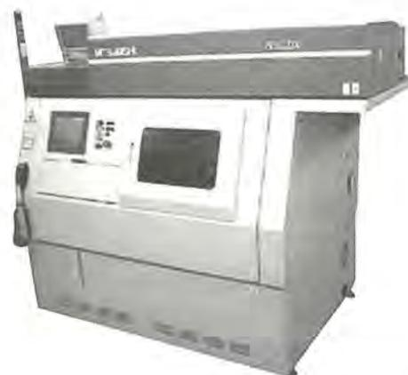
紫外固定レーザー搭載プリント基板穴あけ加工機
