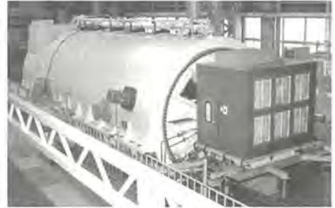
タイ国ラチャブリ発電所納め990MVAタービン発電機
