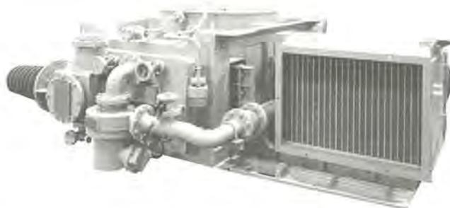
700系新幹線電車で主変圧器
