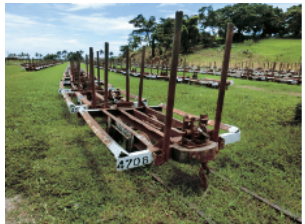
写真-24 サトウキビ運搬貨車には管理番号がついている。貨車の連結端部には、金属製フックのついたワイヤー=ロープと締めあげ機械が設置されていて、これで満載のサトウキビが落ちないようにする。（北を見る。2014年2月23日）
