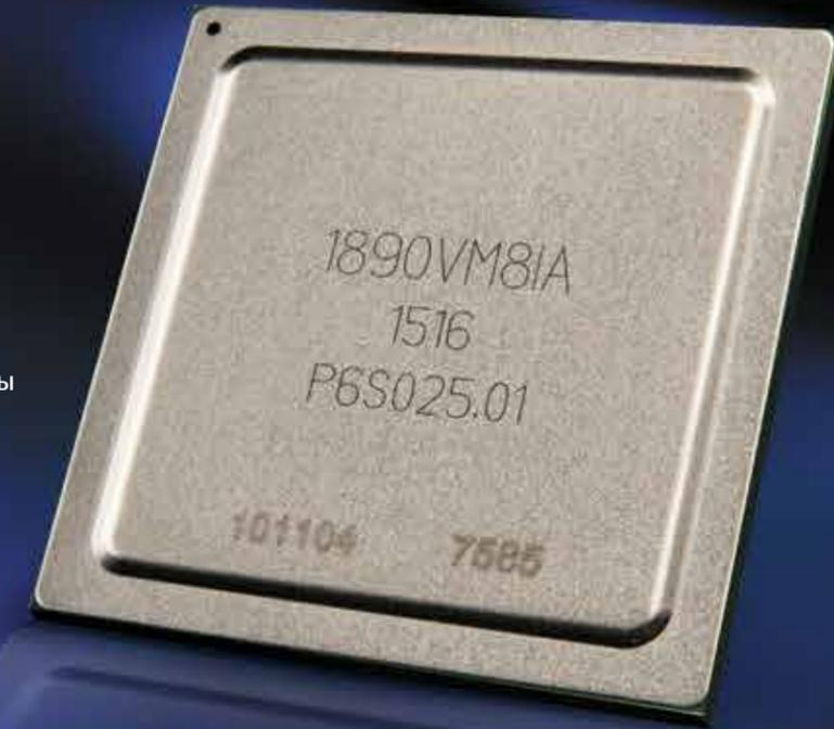
Предназначена для создания высокопроизводительных мобильных и встраиваемых (бортовых) многопроцессорных вычислительных комплексов, функционирующих в режиме реального времени. Включает интерфейс EJTAG.
