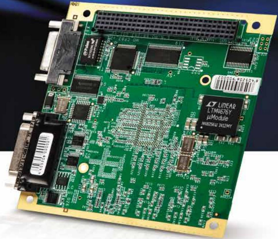
Предназначен для модернизации ЭВМ семейства «Багет» первого поколения.
