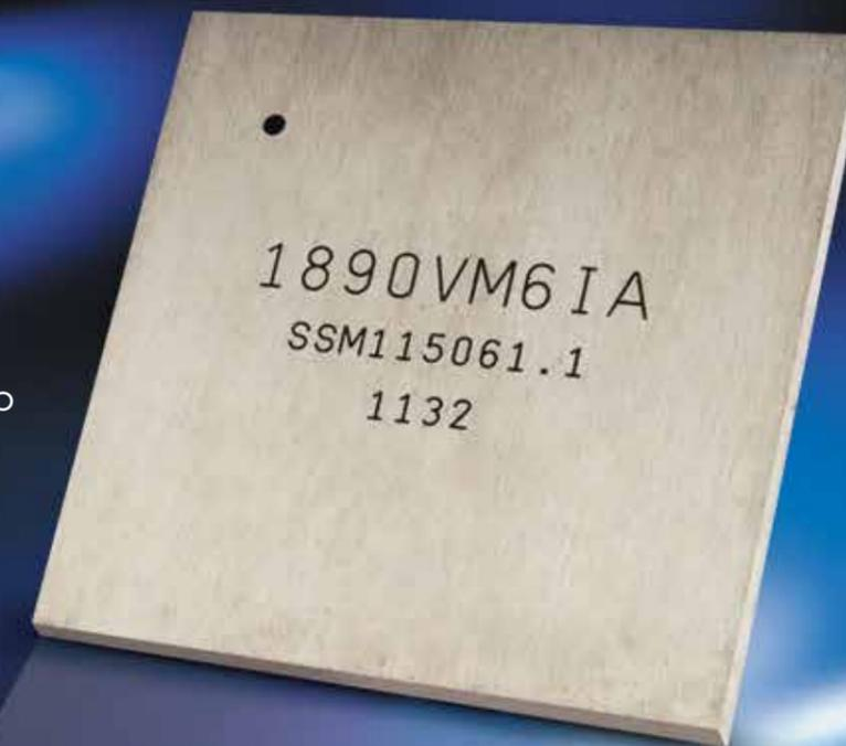
Предназначен для создания вычислительных средств первичной, вторичной и комплексной обработки информации.
