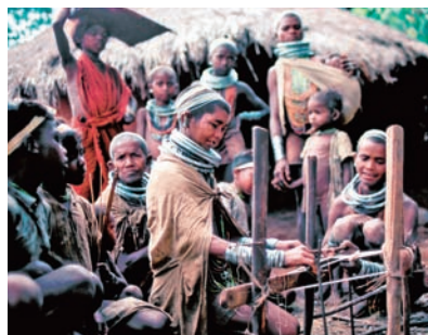
固定式の綜絢をそなえた地機で輪状の織物を織るボンダ人の女性(インド、オリッサ州)。
