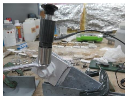
写真-1 アドヒージョン試験状況
