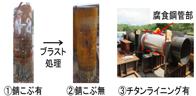
図-8 PEC 計測値への影響検証
