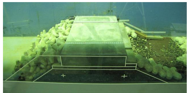
図-10 レベル2津波による変状 (13.63t)
