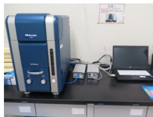
図-5 走査顕微鏡(SEM)
