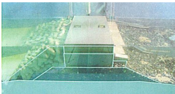
図-11 レベル2津波による変状 (2.8t)
