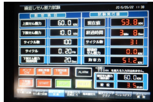
図-3 繰り返しせん断試験の設定画面
