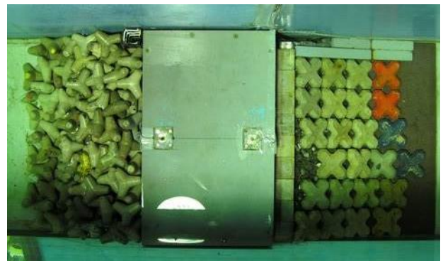
図-9 レベル1津波による変状 (8.09t)
