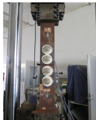
図 6 疲労実験試験体
