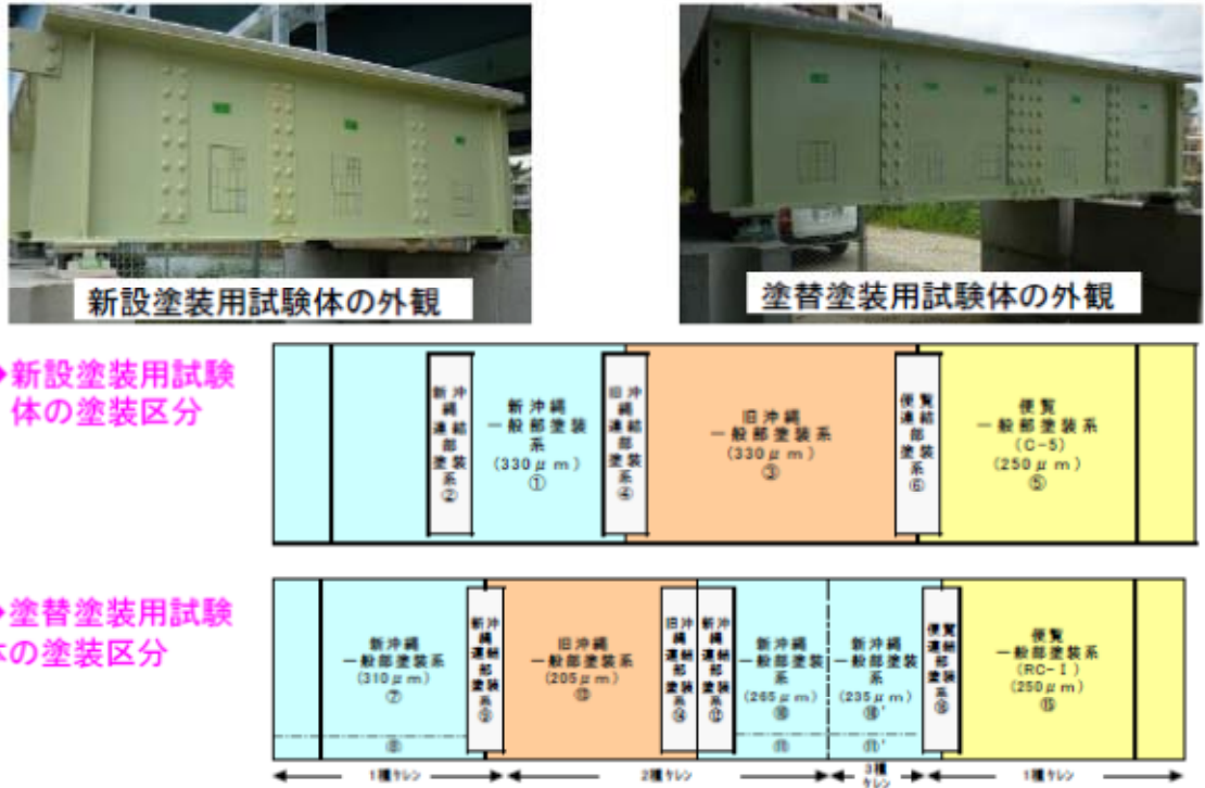
図-4 新牧港橋近くでの試験体による暴露試験
