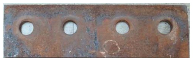
写真 2 摩擦接触面の腐食状態
