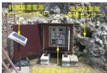
図-1 多重パラメータ観測システム
