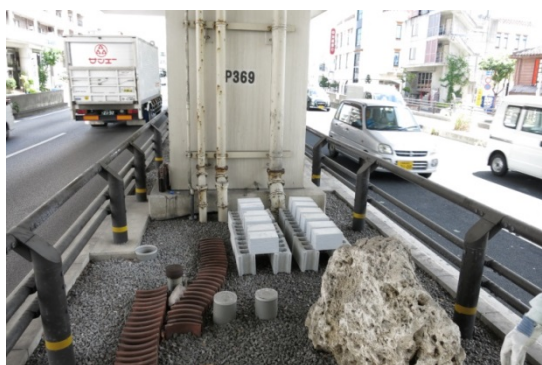
写真-3 中性化暴露試験状況
