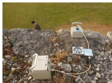
図-2 常時微動計測システム (PicRecord)
