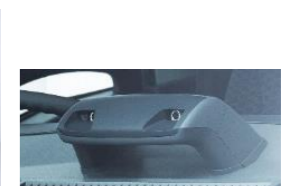
いすゞ自動車 新型「エルフ」のダッシュボードに設置されたステレオカメラ KXタイプ
