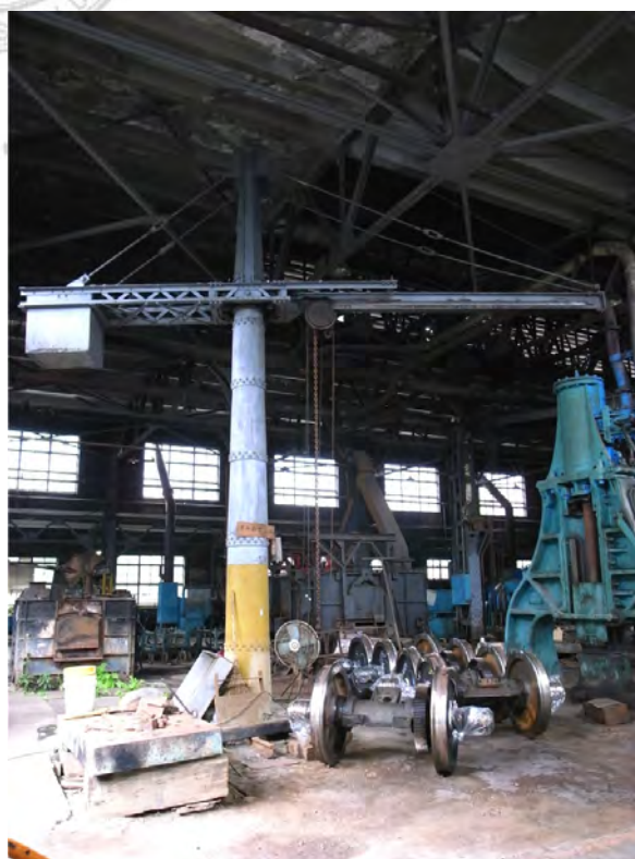
【照片 4-10】左為鉚接式台工 532 柱起重機；右為台工 141 蒸氣錘，1934 年購入。資料來源：本研究拍攝。
