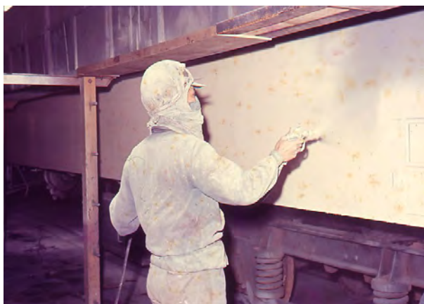
【照片 4-4】車體噴漆作業。資料來源：臺北機廠幻燈片，編號：30，臺北機廠技術組提供。
