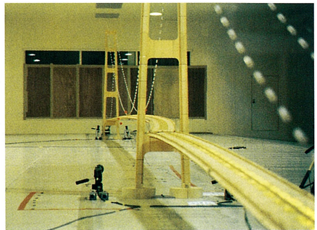
写真－2 超長大橋の全橋模型試験
