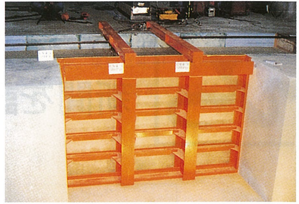
写真－6 基礎特殊実験施設内の大型実験土槽
