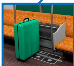
① スーツケース置場
