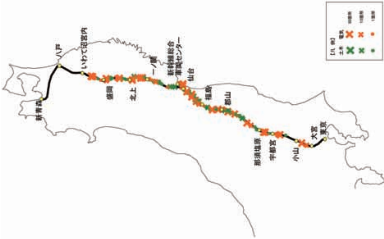
図2.1.6 東北新幹線の地上設備の主な被害と復旧状況（平成23年4月4日発表）
