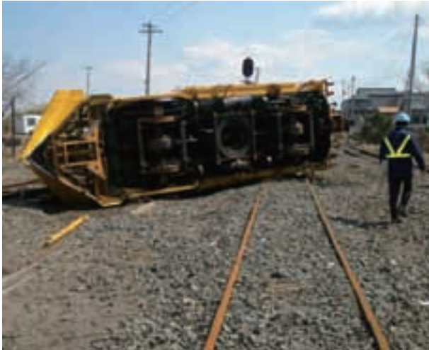
写真 2.2.29 保守用車の転倒（陸中八木駅）
