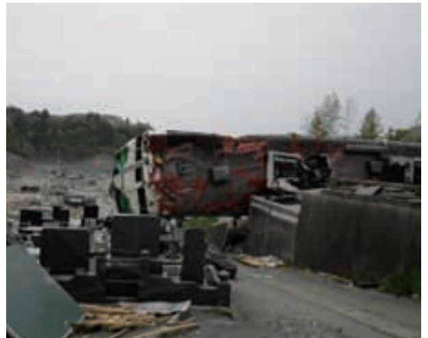
写真 2.2.19 線路から流失した1640D
