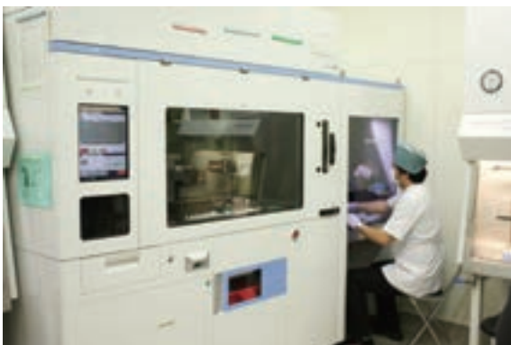
抗がん薬を自動で調製する「ダブルアーム型抗がん薬調製ロボット」
