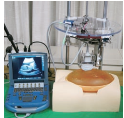
遠隔地の医師がタッチパネルを用いてプローブ(探触子)を操作すると、左のエコー映像と同じものが医師の手元に映し出される
