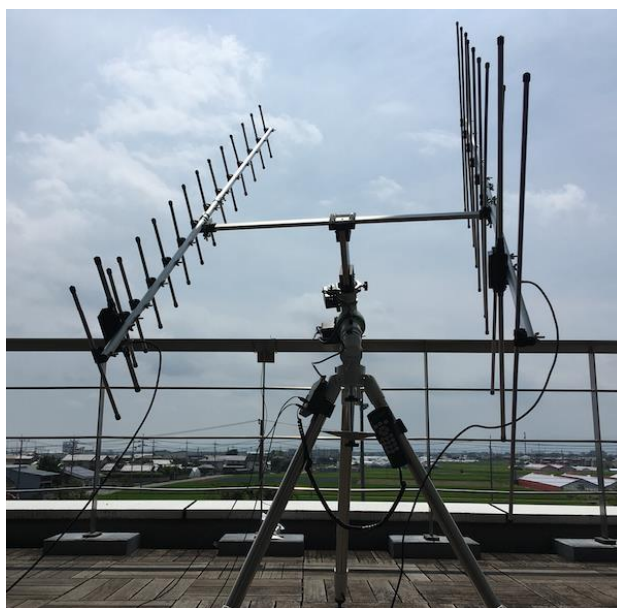
図 1 前橋工科大学内に設置された UHF 帯域(144MHz)と VHF 帯域(430MHz)の無線用アンテナ．天体望遠鏡の自動赤道儀に搭載されており，PC 制御で衛星を追尾して，テレコマ通信する．
