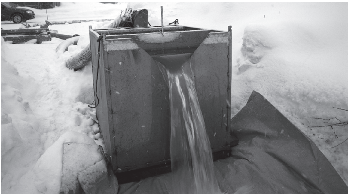
▲宮内地区におけるサケ稚魚生産は、河川水等、飼育環境の不良から、現在発眼卵からの長期飼育生産を行っていない。そのため、飼育水を泊川の伏流水に求め、取水可能性を調査し、稚魚生産施設の整備を検討している。三角堰による水量測定
