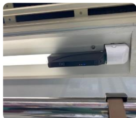
▲室内灯一体型の車内セキュリティカメラ (参考)搭載試験の様子
