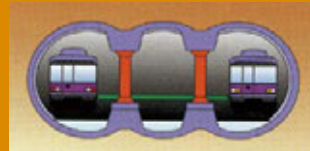
三連一体型シールド工法によるシールド駅
