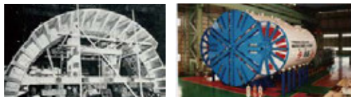
(左) 丸ノ内線ルーフシールド (右) 南北線着脱式3連シールド
