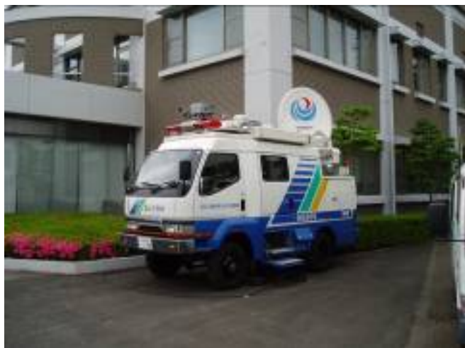
石楠花センター(避難所)への復旧作業映像提供用の衛星通信車(国交省)
