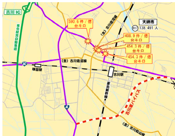
▲国道108号現道区間の死傷事故率（400件/億台キロ以上）
