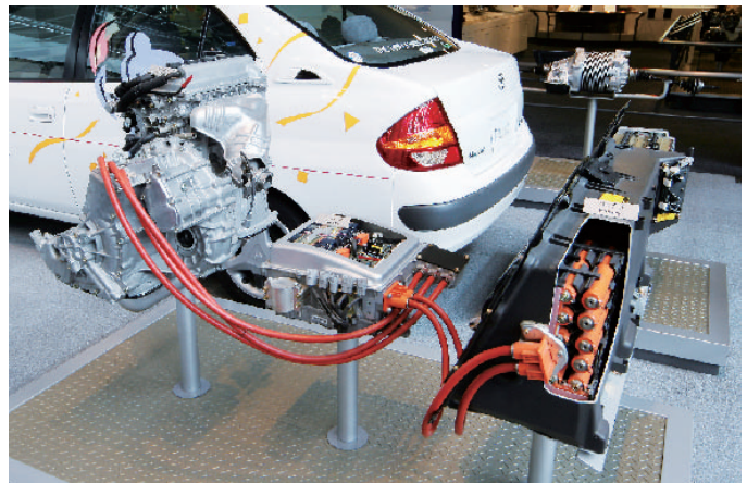
THSに使われたエンジン、インバータ、バッテリー。
