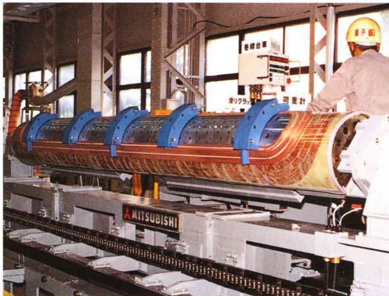
写真6.3 巻線機を使ったコイルの巻き線作業状況 巻き付けられる線材にかかっている張力を一定に保つために、このコンピューター制御の巻線機が開発されました。
