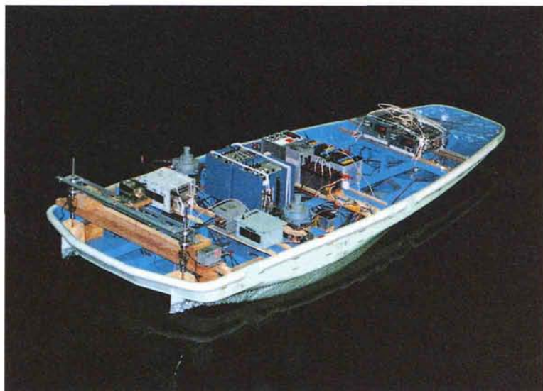
写真8.4 模型船を使った運動性能試験の状況
