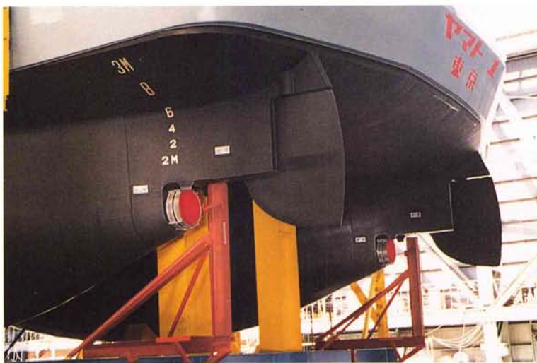
写真2.3 「ヤマト-1」の海水の取り入れ口と噴き出し口
