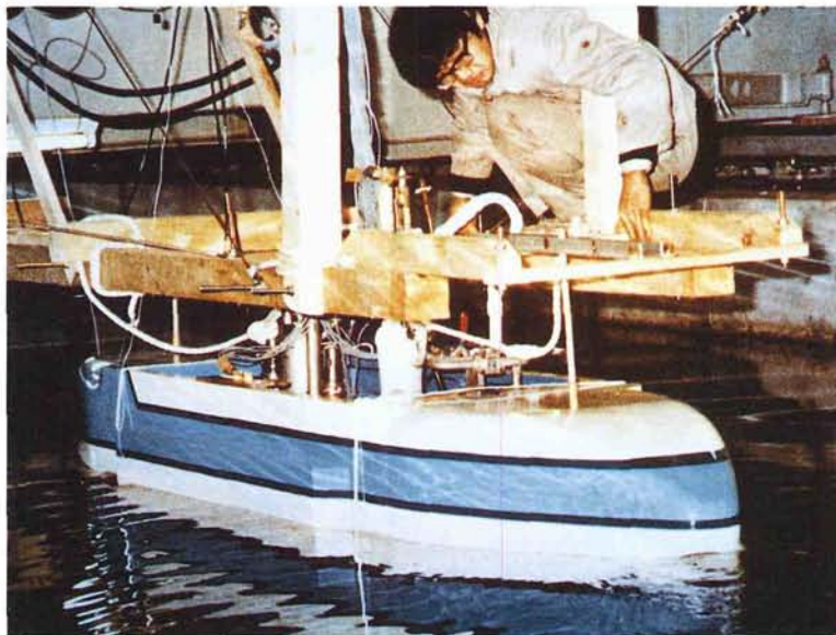
写真1.2 神戸商船大学の水槽を走る超電導電磁推進模型船「ST-500」(1979年) (神戸商船大学名誉教授 佐治吉郎氏のご好意による)
