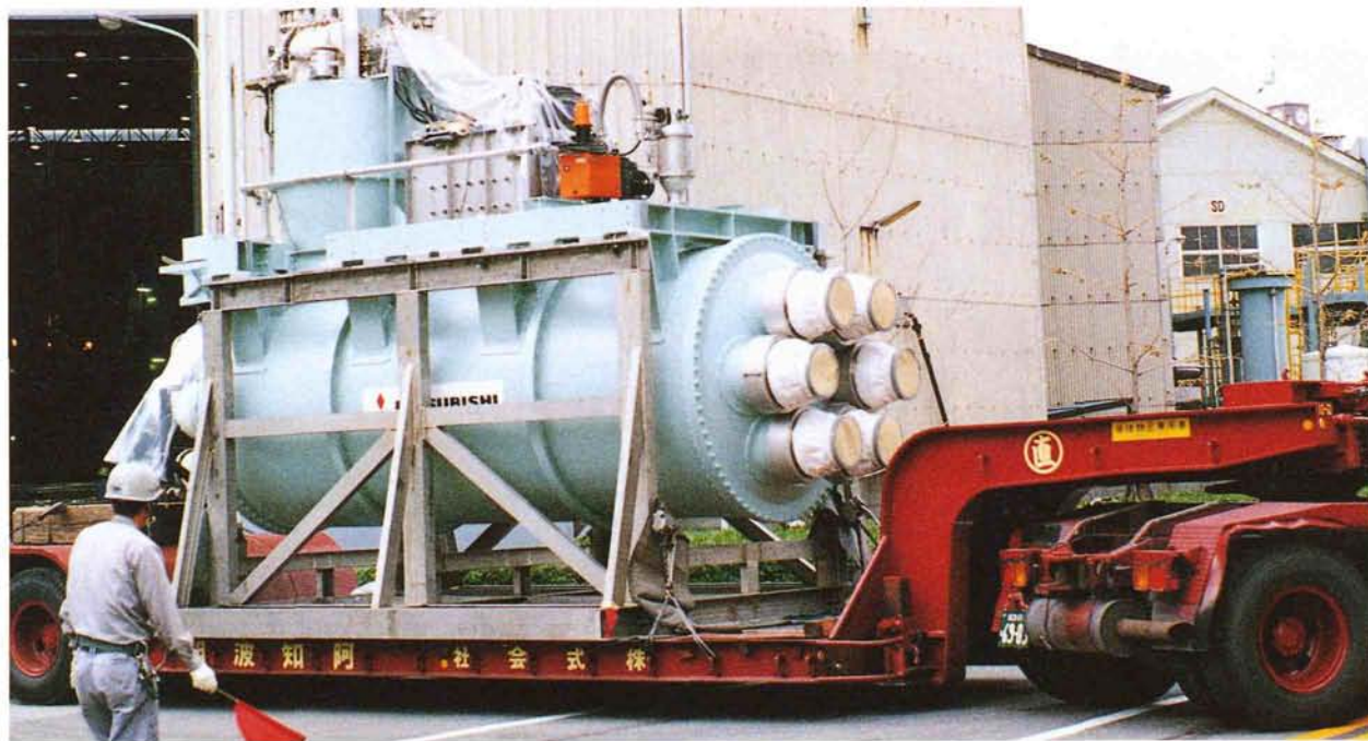
写真 6.7 完成した超電導電磁推進装置の全景（三菱重工製）
