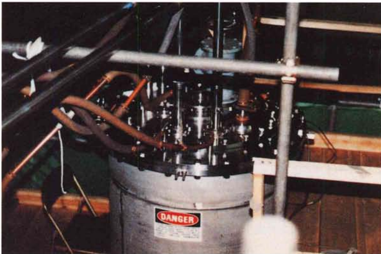
写真 8.1 単体コイルの励磁試験状況
