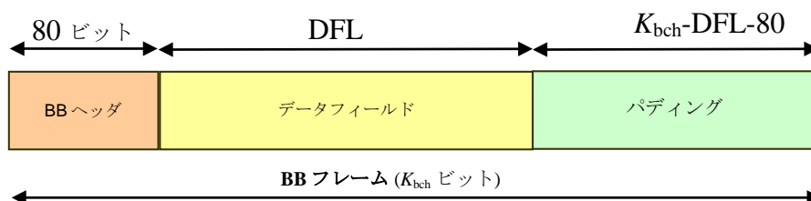
図 7.4-10 ストリームアダプタ出力に於けるBBフレームの形式
