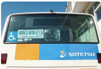
バックアイカメラを設置した車両
