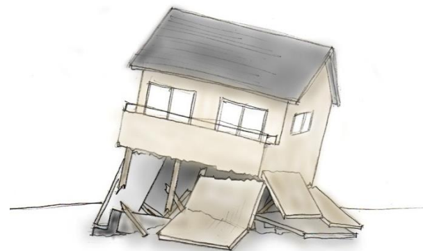
（基礎及び1階部分が崩れた住宅）
