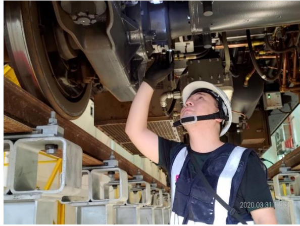
圖 5 電聯車輪軸檢查
