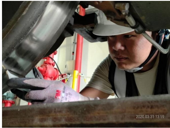
圖 6 電聯車輪緣檢查
