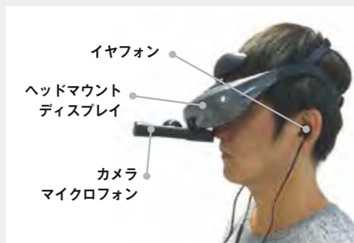
▲ヘッドマウントディスプレイ型知覚体験シミュレータ
