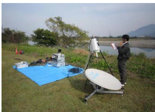
図 2.21 衛星小型画像伝送装置
