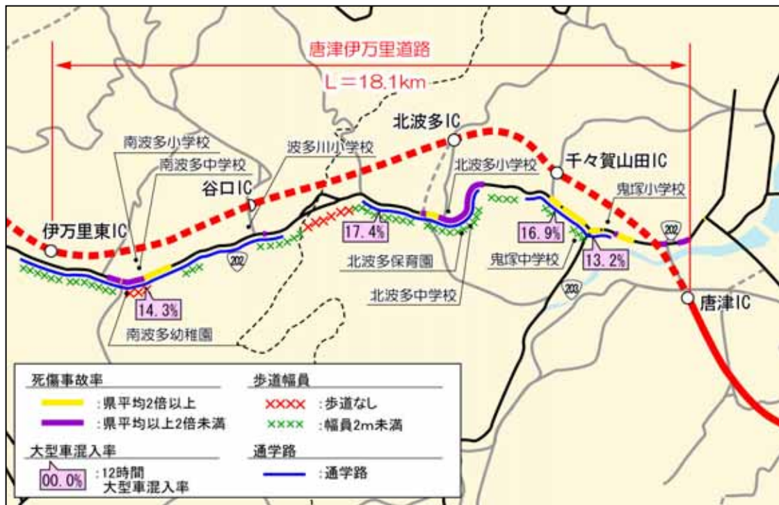
国道 202 号の死傷事故率・大型車混入率及び歩道整備状況
