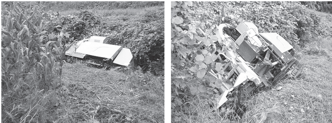
図3 ほ場の境界を認識できず転落した収穫機
