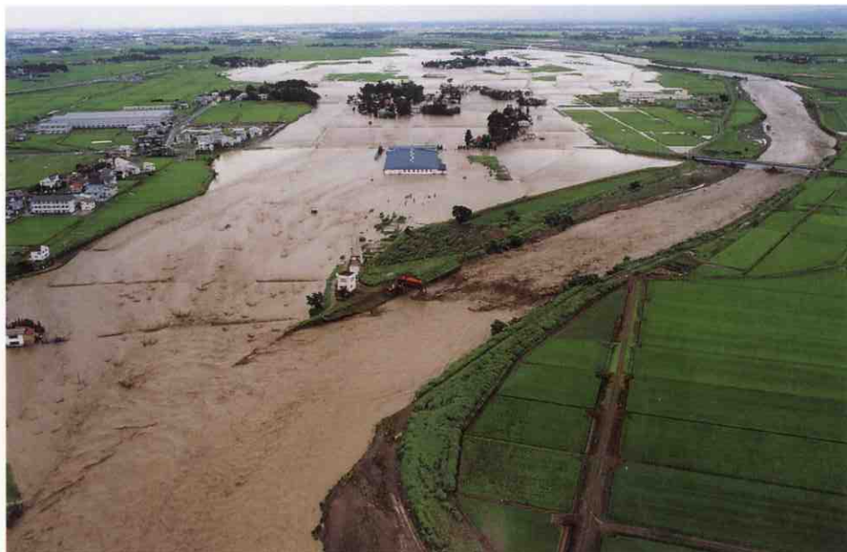
関川の渋江川合流点左岸下流が約200mに渡り破堤し、濁流が氾濫(新井市月岡)
