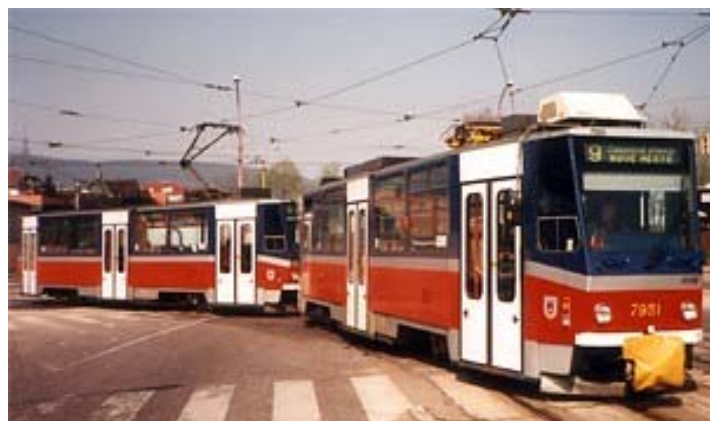
Obr. 3: Električkové vozidlo typu Tatra ČKD T6A5
