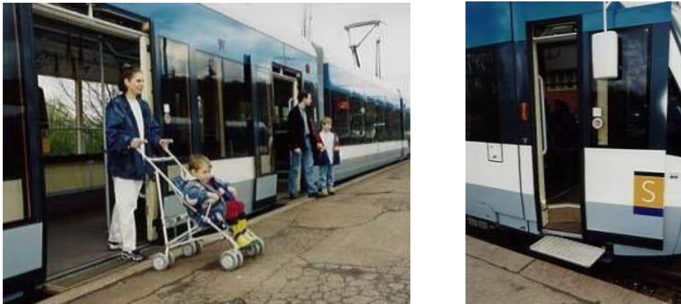
Obr. 9: Vysunutie nástupnej plošiny z duálneho vozidla
