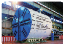
本工事に使用したシールドマシン(直径8.26m)
