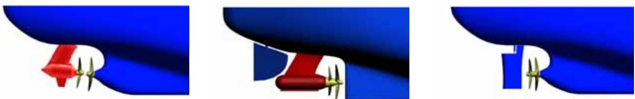
図7 電気推進船に適したMB船型
