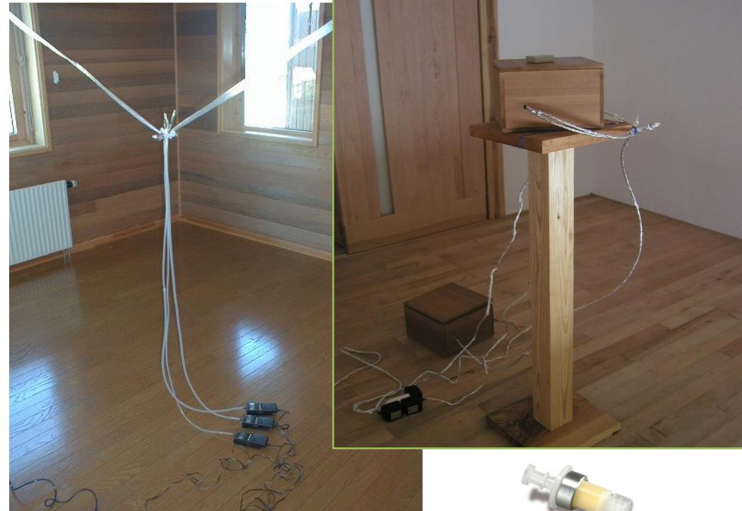
アクティブガスサンプラーによる室内空気質サンプリング例
