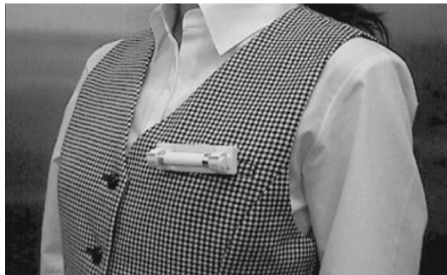
パッシブサンプラーによる個人暴露量サンプリング例
