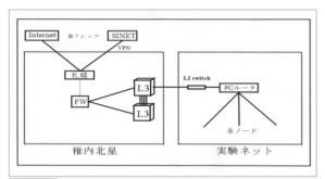
図 15 稚内北星・実験ネット 接続図
