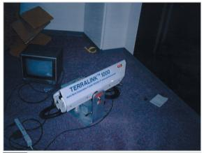
図8 稚内商工高校向けレーザ光空間通信装置 (稚内北星)
