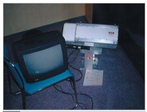
図7 稚内高校向けレーザ光空間通信装置(稚内 北星)
