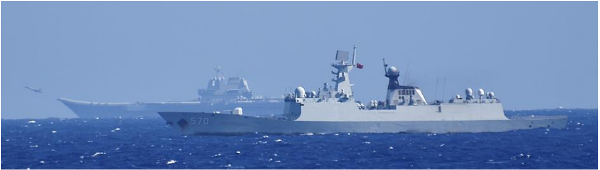
クズネツォフ級空母「山東」(艦番号「17」)(奥)及びジャンカイⅡ級フリゲート(艦番号「570」)(手前)
