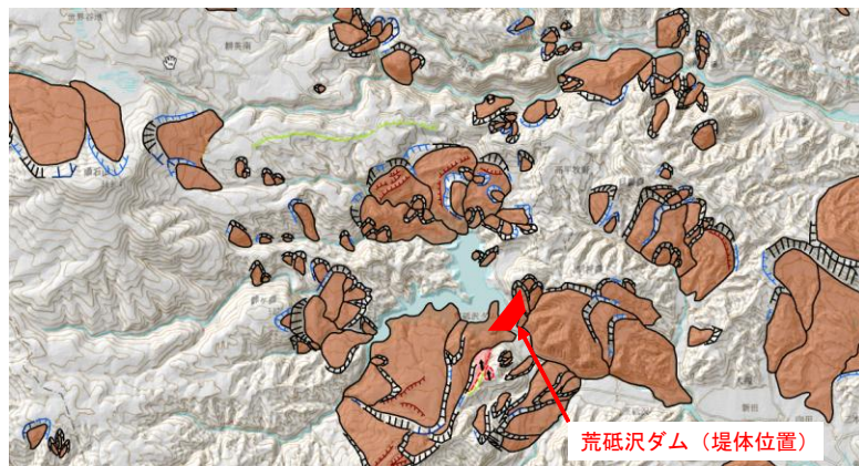
図-12 荒砥沢ダム周辺の地すべり地形
