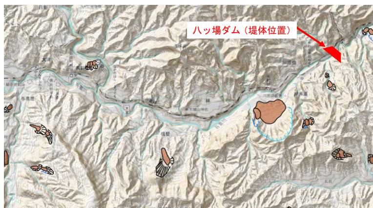
図-9 ハッ場ダム周辺の地すべり地形
