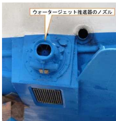
写真8 ウォータージェット推進器のノズル
