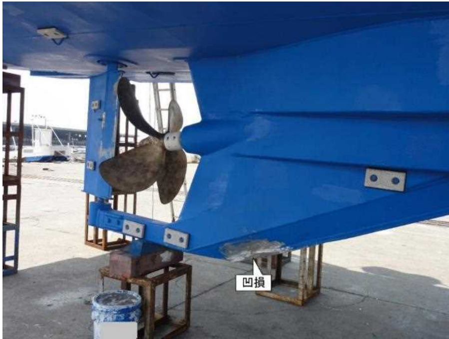
写真6 シューピースの損傷状況
