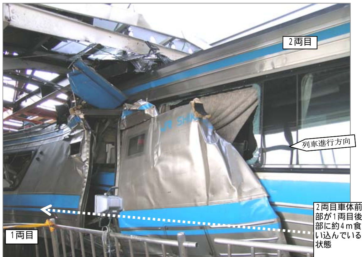
写真2 1両目の損傷状況（車体後部左側）
