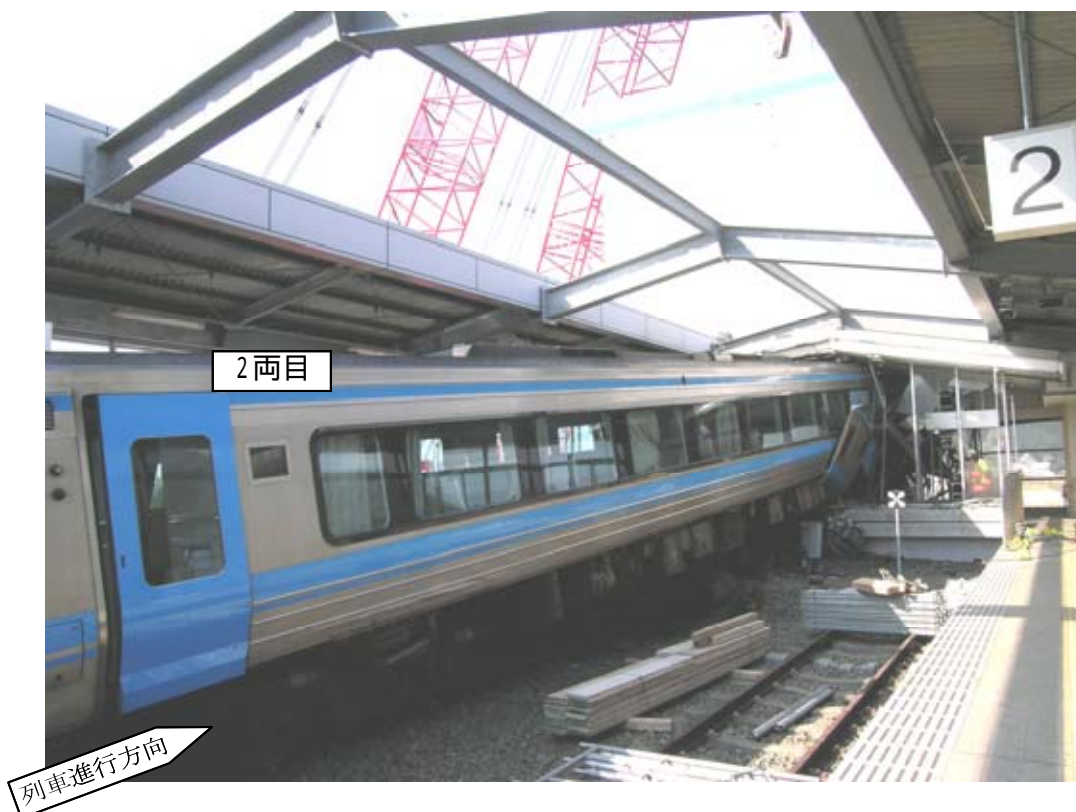
写真6 2両目の損傷状況（車体右側）
