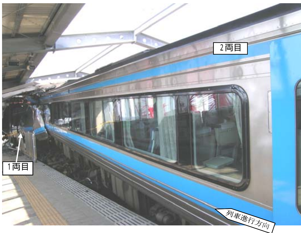
写真5 2両目の損傷状況（車体中央部左側）
